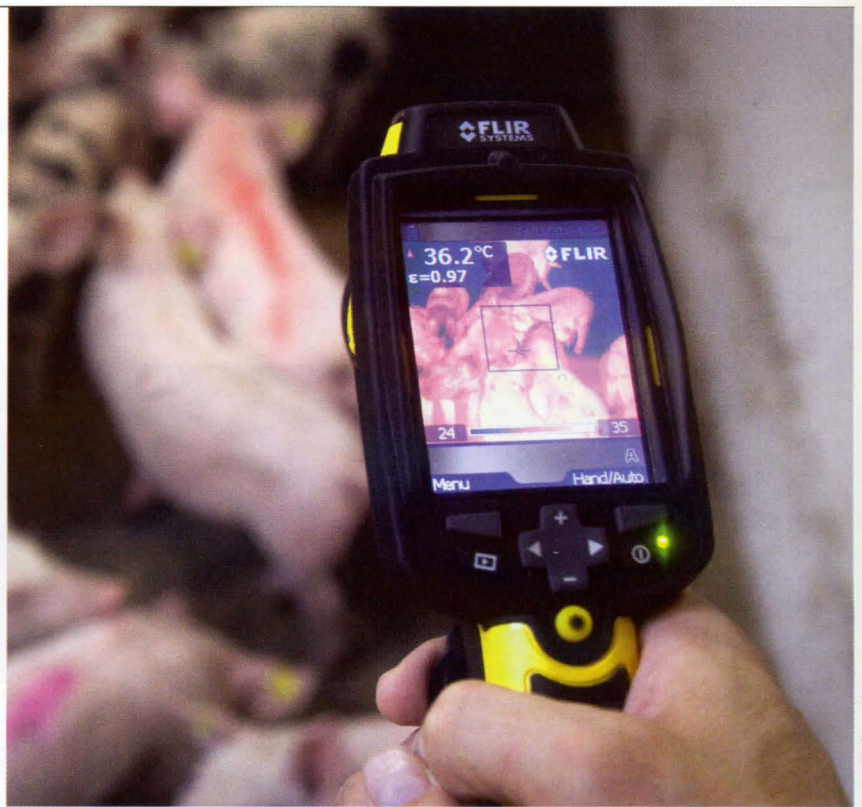
Met een infraroodcamera is van een afstand de temperatuur in de ooghoeken te meten. Dat geeft een goede indicatie en voorkomt stress.
